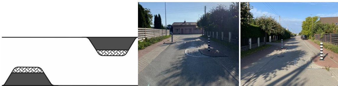
pav. 7.2 Iškreivavimo elementų išdėstymo formuojant važiuojamosios dalies iškreivinimą su susiaurinimu schema ir pavyzdys
