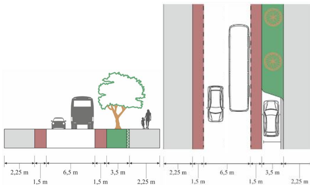
pav. 7.1 \leq 30 km/h greičio režimo gatvės skersinis profilis su maršrutinio transporto eismu
