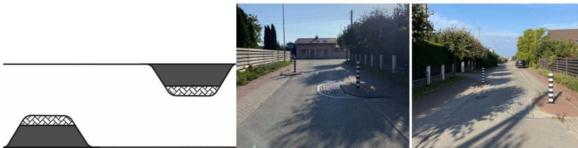
pav. 7.3 Iškreivavimo elementų išdėstymo formuojant važiuojamosios dalies iškreivinimą su susiaurinimu schema ir pavyzdys
