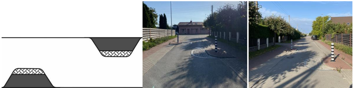
pav. 7.2 Iškreivinimo elementų išdėstymo formuojant važiuojamosios dalies iškreivinimą su susiaurinimu schema ir pavyzdys
