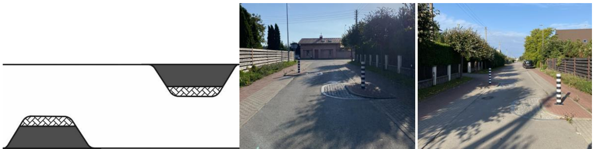
pav. 7.2 Iškreivavimo elementų išdėstymo formuojant važiuojamosios dalies iškreivimą su susiaurinimu schema ir pavyzdys
